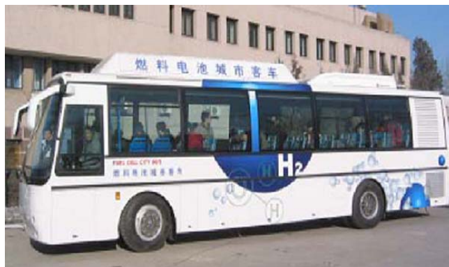
Abbildung 14: Brennstoffzellenbus von Tsinghua Universität und Dalian Institut (Quelle: Fuelcelltoday)
